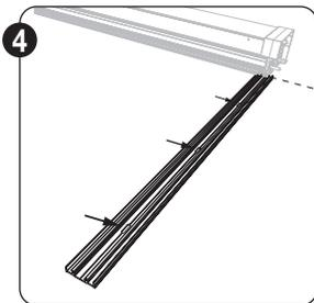
4 Das feste Profil der Koppelseitenführung wird mittig alle 250 mm über das abnehmbare Profil der Vorhangfassade an der Klemmleiste befestigt. Dieses Profil ist mit Langlöchern  $\varnothing 5 \text{ mm} \times 20 \text{ mm}$ , alle 250 mm angebracht, vorgebohrt. Positionieren Sie die Oberseite dieses festen Profils genau an der Stelle, an der die Kassette platziert werden muss. Unten befindet sich das Profil 4 mm über der Unterseite des Screens, hier wird später eine Grundplatte hinzugefügt.
